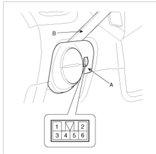
3. 检查光照度。当转动变阻器时,照明灯光亮度应没有任何闪烁平滑改变。如果不符合要求进行更换。
